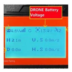
REFERENCE IMAGE OF THE REMOTE CONTROL LCD DISLAY SCREEN WHEN THE REMOTE IS POWERED ON. NOTE THE BATTERY VOLTAGE INDICATOR IS SHOWN AS 15.4V
